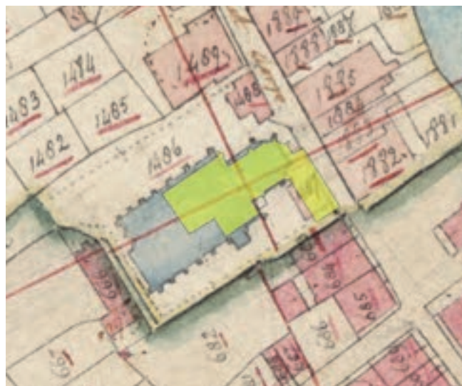
Afb. 5.7. Projectie van het huidige gebouw op basis van de topografische kaart (geel) op het kadastrale minuutplan uit ca. 1830. Bij het koor heeft de landmeter niet alle steunberen weergegeven. Te zien is dat dwarsbeuk van de huidige kerk overeenkomt met het transept van de middeleeuwse kerk.
